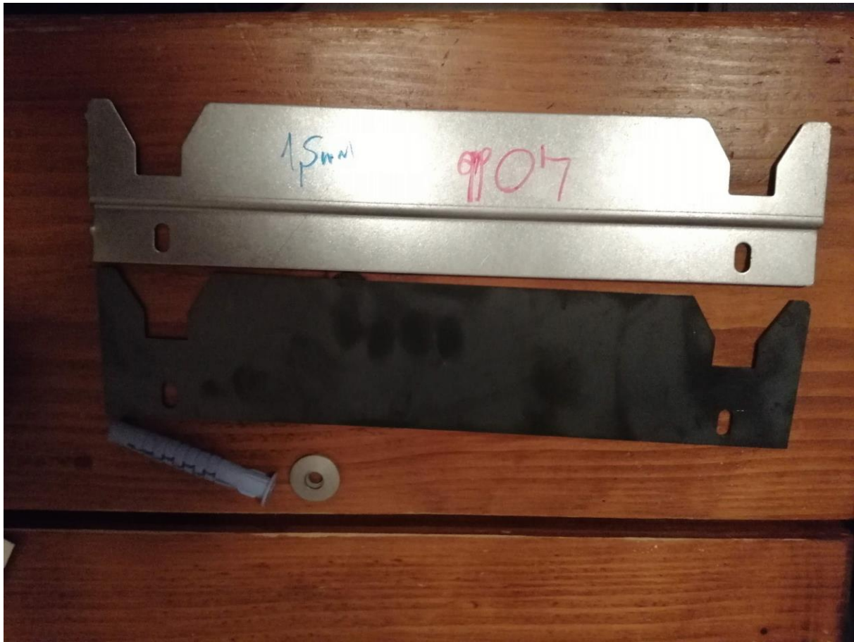
UTÁNGYÁRTOTT SÍN – fekete színű, utólag horganyfestéssel lefestve + dübel + alátét (megj.: az ezüstszerű sín az eredeti, gyári termék)
